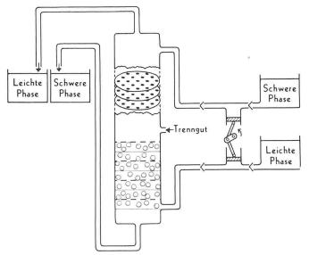
Bild 2. Schematische Darstellung der Gegenstrom-Extraktion in Puls-
