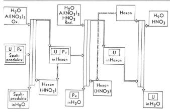
Bild 3. Erster Extraktionszyklus des «Redox»-Prozesses zur Plutoniumgewinnung mit drei Gegenstromkolonnen
