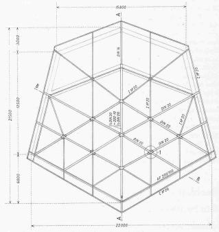
Bild 5. Dachkonstruktion, Grundriss 1:300
