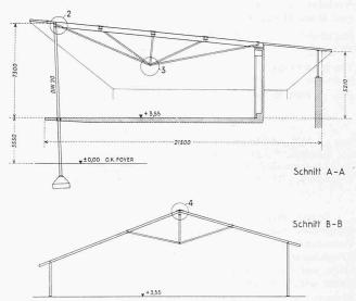
Bild 6. Dachkonstruktion, Schnitte 1:300
