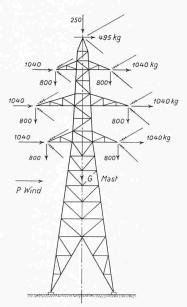
Bild 2. Belastungsschema für den Abspanneckmast einer 225-kV-Leitung. Leitungswinkel: 166°, Spannweite 450 m, Leiter 6×400 mm² Aldrey
