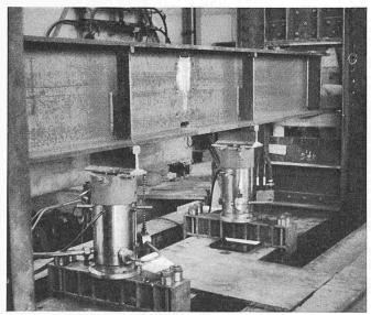
Bild 2. Versuchsträger I im Pulsator
