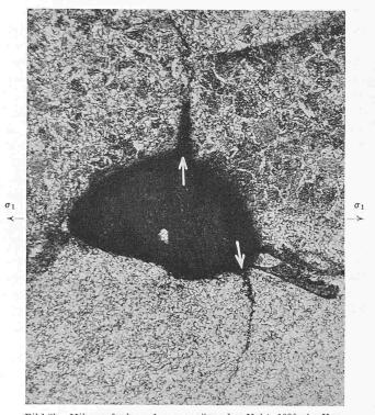
Bild 3b. Mikroaufnahme der ungenügenden Naht, 100fache Vergrösserung. Schlackeneinschluss zwischen zwei Schweissraupen mit Anrissen
