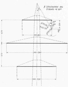
Bild 1. Leiterbild des Tragmastes einer 225-kV-Leitung
