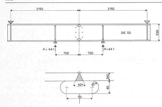
Bild 1. Versuchsträger I mit Detail 1:5
