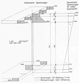
Bild 5. Spannungsverteilung im Stossquerschnitt aus statischer Belastung mit max. P  $=44~\mathrm{t}$
