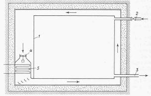
Bild 2. Gaslagerraum mit eingebautem Luftkühler
