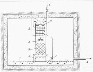
Bild 1. Gaslagerraum für beliebige O2- und CO2-Gehalte
