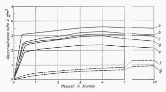
Bild 1. Wasseraufnahme verschiedener Papiersorten in g/m<sup>2</sup>; Luftzustand im Druckraum 20° C, 63 %; Luftzustand im Lagerraum bei Kurven a bis e 20 °C, 30 %
