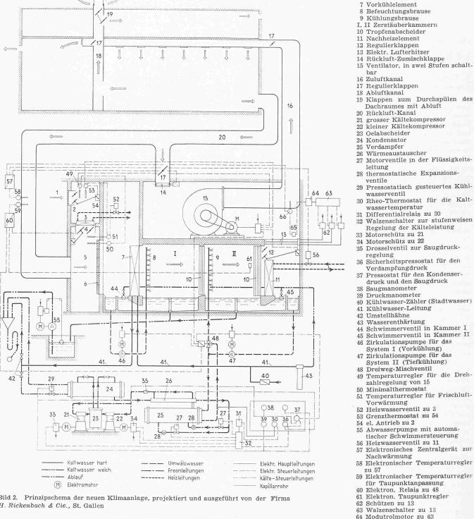
Bild 2. Prinzipschema der neuen Klimaanlage, projektiert und ausgeführt von der Firma H. Rickenbach & Cie., St. Gallen
