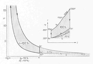
Bild 7. Arbeitsdiagramm eines unaufgeladenen Motors mit zusätzlicher Expansionsspitze bis auf den Umgebungsdruck, bzw. bis auf die Umgebungstemperatur. Oben zugehöriges T-s-Diagramm.
