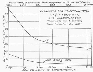
Bild 6. Zeitliche Entwicklung der Kriech-Parameter für Massenbeton
