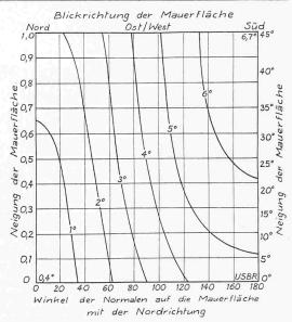
Bild 8. Mittlere Erwärmung der Maueroberfläche über die mittlere Jahrestemperatur infolge Sonnenbestrahlung, in  $^{0}$ C (Westen der USA, 45 bis  $50\,^{0}$  nördliche Breite)
