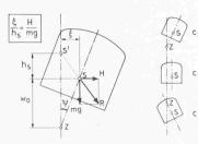
Bild 25. Kurvenverhalten. Unter dem Einfluss der Zentrifugalkraft H neigt sich der Wagenkasten durch Drehung um das Zentrum Z zur Seite. Die Resultierende R aus Gewicht mg und H geht durch den Kippschwerpunkt S';  $h_{\rm S}=$  scheinbare Schwerpunktserhöhung
