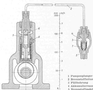
Bild 1. Prinzip einer Akkumulier-Einspritzanlage. Die abgemessene Fördermenge der Pumpe 1 wird über eine Füllbohrung 3 im brennstoffgefüllten Akkumulierraum 4 des Einspritzventils unter entsprechendem Druckanstieg gespeichert
