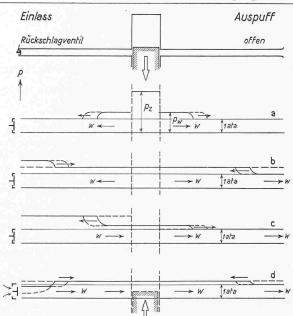
Mit den verschiedensten Einrichtungen dieser Art wurden im Institut Diesel- und auch Benzineinspritzmotoren betrieben und durchgemessen. Eine extrem kleine Pumpe wurde bis zu 6000 U/min, das sind 100 Einspritzungen in der Sekunde, geprüft. Dabei zeigten die mit Piezoquartz aufgenommenen Füll- und Entlastungsdruckwellen in der Leitung und unmittelbar zwischen Nadelspitze und Düsenloch ein sauberes Arbeiten, und die mit einer Messtrommel aufgenommenen Spritzbilder bestätigen die Präzision.
