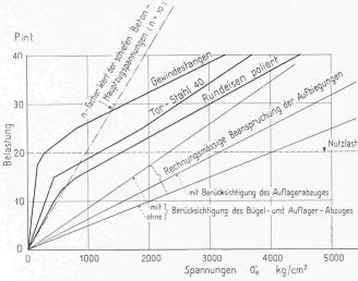
Bild 17. Rechnungsmässige und wirkliche Beanspruchung der Schrägeisen (Schubsicherung). (Die Berechnungen basieren auf dem Schubdiagramm nach Mörsch; die angegebenen gemessenen Beanspruchungen sind Mittelwerte aus den Messtellen links und rechts)
