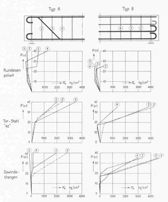
Bild 19. Beanspruchung der Bügel bei verschiedenen Verbundeigenschaften der Armierungsstähle. (Die gestrichelten Kurven geben jeweils die Vergleichsresultate der Bügel aus gewöhnlichem Beton-Rundstahl)
