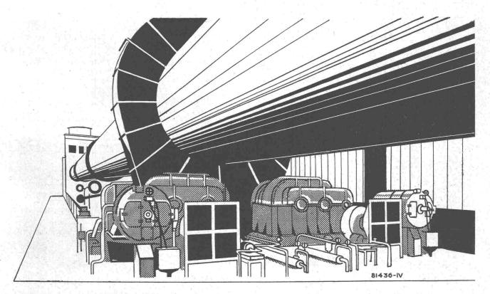
Regelbarer Antrieb zu einem der grössten Drehöfen der Welt mit zwei Dreiphasen-Nebenschluss-Kommutatormotoren von je 220 PS Nennleistung
