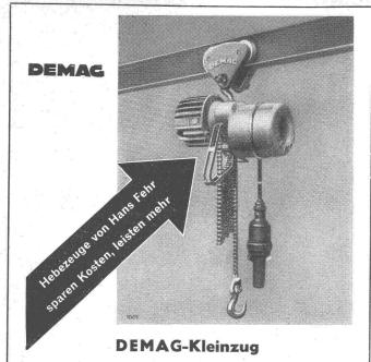
mit Verschiebeankermotor, Konusbremse und Präzisions-Rollenkette. Trägkraft bis 500 kg, mit und ohne Feinhub. Dank seiner Herstellung in grossen Serien ist er ausserordentlich preiswert und verdrängt je länger desto mehr den unrationellen Handbetrieb. Verlangen Sie Prospekte SDZ U 2.
