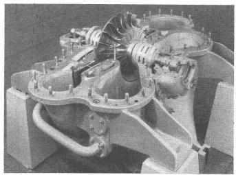
Einstufiger Sulzer-Radialverdichter zur Förderung von 7 m³/s Leuchtgas auf 0,2 atü, mit abgehobenem Oberteil. Die Durchführungen der Welle durch das Gehäuse sind mit Flüssigkeitsstopfbüchsen ausgerüstet, die jedes Austreten von Gas oder Eindringen von atmosphärischer Luft verhindern. Bei Förderung atmosphärischer Luft würde mit der gleichen Maschine ein Enddruck von etwa 1 atü erreicht.
