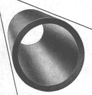
Toleranz des Innen- $\varnothing$  0,05 mm Oberflächengüte 1 bis 2  $\mu$  (Unebenheiten der Oberfläche)
