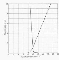
Bild 2. Temperatur-Verteilung bei Strahlungsheizung (ausgezogen) und Luftheizung (gestrichelt)
