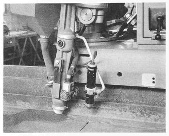
Bild. 8. Schweissdüse für Unterpulverschweissung mit angebauter Strichfadenlampe. Die Düse befindet sich in sogenannter nachlaufender Stellung. Durch die Pulveraufhäufung wird die Sicht auf die Elektrodenstellung verhindert. Der Lichtpunkt der Lampe wird entsprechend der Elektrodenstellung auf die Naht gerichtet
