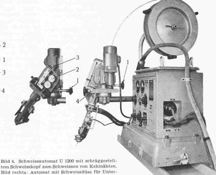
pulverschweissung mit Schweisspulverbehälter, Kulisse und an der Düse angebauter Strichfadenlampe, Detail links: Automat mit einer Schweissdüse für Blankdraht und Netzmantelelektroden, ohne Pulverbehälter.
