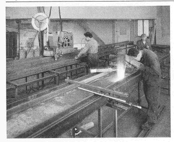
Bild 7. Schweissautomat U 1200 beim Schweissen von 6 m langen Trägern für Staumauerschalungen. Im Vordergrund wird in einer Spannvorrichtung der Steg zwischen die T-Träger geheftet. Mit dem Schweissautomaten werden dann die 8 mm starken Stumpfstösse, ohne Anschrägung der Kanten, mit je einer Schweisslage von beiden Seiten stumpf verschweisst. Damit der Automat voll beschäftigt ist, müssen für das Heften der Träger gleichzeitig zwei Schweisser eingesetzt werden
