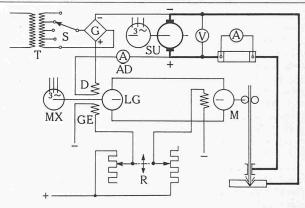
Bild 6. Prinzipschema des Schweissautomaten U 1200. Die vollautomatische Zündung des Lichtbogens und das Fehlen von störanfälligen Elementen, wie z. B. Röhren, Relais, Rutschkupplungen, erhöhen die Wirtschaftlichkeit des Schweissautomaten
