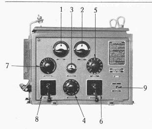
Bild 5. Steuerkasten mit Instrumenten und Schaltelementen. Die übersichtliche Anordnung der Instrumente und Bedienungselemente erlaubt besonders bei der Unterpulverschweissung den Schweissvorgang zu verfolgen, um beste Schweissqualitäten zu erzielen
