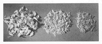
Bild 11. Bohrloch-Proben des Bauholzes nach zehnjährigem Bestand der Brücke
