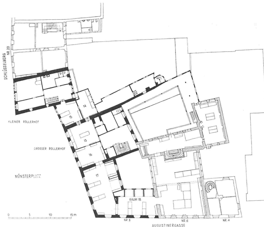
Grundriss des ersten Obergeschosses nach vollendetem Umbau: erste Bauetappe schraffiert, zweite Bauetappe schwarz. Masstab 1:500.
