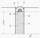
Bild 9. Kupplung von zwei Tunnelteilstücken, Ansicht von oben.
