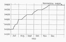
Bild 69. Verlauf des Aareaufstaues
