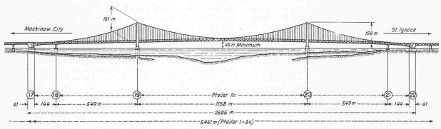
Bild 1. Die Mackinac-Hängebrücke, Masstab 1:17 800
