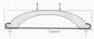
Bild 3. Druckbogen mit Zugband (Tragsystem, das sich einstellt, wenn die Längsarmierung gleiten kann)
