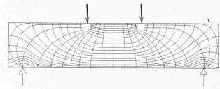
Bild 1. Spannungtrajektorien der verwendeten Versuchsbalken bei ungerissenem Beton (homogener Zustand)
