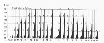
Bild 8b. Balken Typ B (Orthogonalarmierung) Gewindestangen
