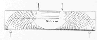
Bild 2. Schematischer Verlauf der Spannungstrajektorien bei gerissenem Zustand des Betons.
