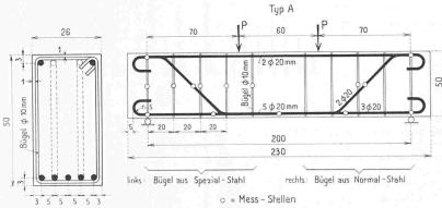
Bild 5a. Versuchsbalken Typ A. (Trajektorienarmierung)
