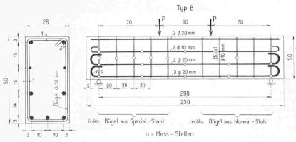
Bild 5b. Versuchsbalken Typ B. (Orthogonalarmierung)
