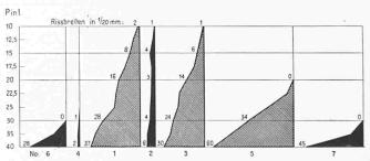
Bild 8e. Balken Typ A (Trajektorienarmierung) pol. Rundeisen
