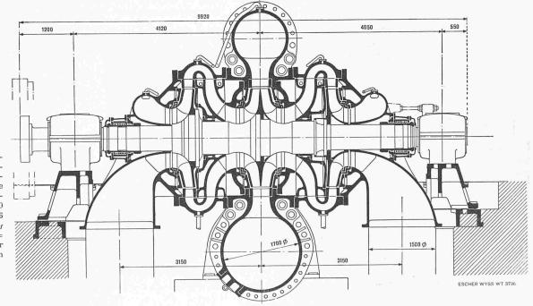
Bild 9. Horizontalachsige, doppelseitige, zweistufige Speicherpumpe des Werkes Providenza  $H_f=240$  bis 286 m;  $Q_f=16$  bis 12,4 m³/s;  $P_M=63\,000$  PS;  $n=450\,$  U/min (später 500 U/min wegen Frequenzänderung)
