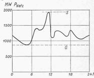
Bild 2. Verlauf der Netzbelastung  $P_{Netz}$  in MW am 16. Sept. 53 auf dem Gebiet der Schweiz («Bulletin SEV», 1953)
