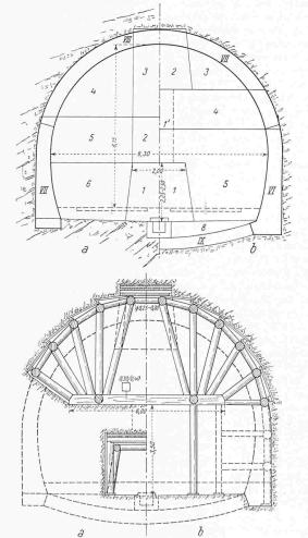
Bild 12 (links). Schema der österreichischen Bauweise
