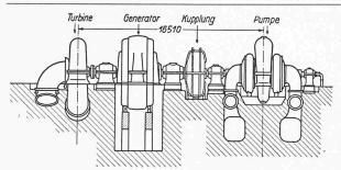
Bild 3. Speichergruppe des Kraftwerkes Herdecke/Ruhr. Horizontalachsige, doppelseitige, zweistufige Pumpen mit regulierbarem Leitapparat.  $H_f=146.4~\mathrm{m}$ ;  $Q_f=14.6~\mathrm{m}^3/\mathrm{s}$ ;  $n=300~\mathrm{U/min}$ ;  $P_M=36~100~\mathrm{PS}$
