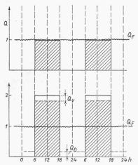
Bild 1. Natürliche Speicherung im 24stündigen Ablauf an einem kleinen Fluss (Tages- bzw. Nacht-Speicherung)  $Q_F$  Sekundliche Wassermenge des un-
