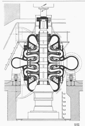
Bild 10. Schnitt durch die vertikalachsige, doppelseitige, zweistufige Speicherpumpe Oberaar.  $H_f=400~\mathrm{m}$ ;  $Q_f=4~\mathrm{m}^3/\mathrm{s}$ ;  $n=1000~\mathrm{U/min}$ ;  $P_M=\sim25~100~\mathrm{PS}$
