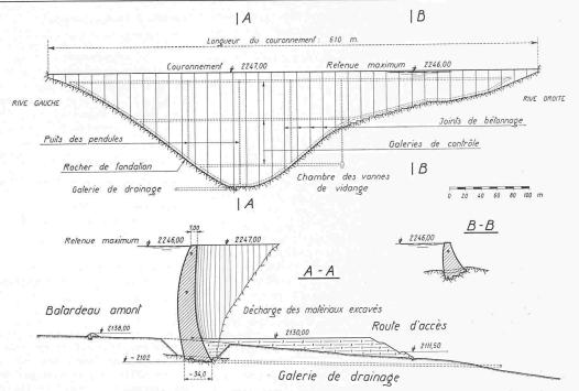
Bild 5. Staumauer Moiry, wasserseitige Ansicht und Querschnitt 1:4000
