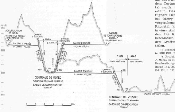
Bild 2. Kraftwerke Gougra, Längenprofil 1:125 000/1:25 000
