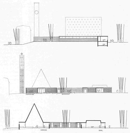
Oben Südansicht, Mitte Westansicht, unten Querschnitt Nord-Süd, Masstab 1:700
