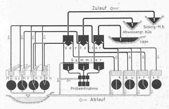
Bild 25. Schema der Kontrollstation Chemische Werke Hüls
