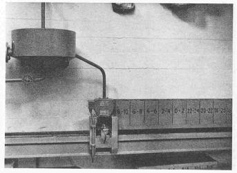
Bild 21. Entnahmekästen mit automat. Anpassung an die Probenahmezeiten
