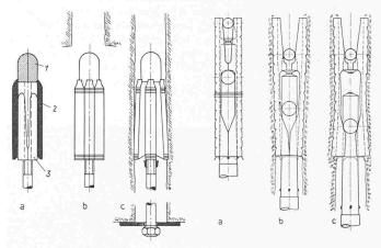
Bild 14. Verankerungsbolzen System «Ancrall», a Schnitt: 1 Holzkörper mit Gummihaube, 2 bewegliche Keile, 3 konisches Sechskant; b Ansicht vor und c nach dem Spreizen der Keile.
