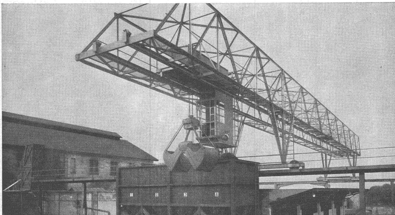
Verladebrücke in Schweisskonstruktion 2,5 t Tragkraft, 46 m Länge
