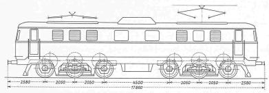
Bild 9. Schnellzugslokomotive Reihe 1010. — Alle Typenskizzen Masstab 1:175
