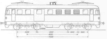
Bild 13. Gepäcktriebwagen Reihe 4061
