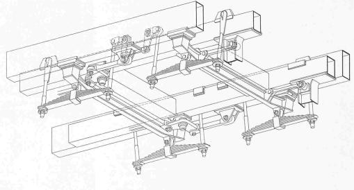
Bild 11. Drehgestell ohne Drehzapfen der Lokomotive Reihe 1010
