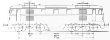
Bild 16. Schnellzugslokomotive Reihe 1241 (Entwurf)
