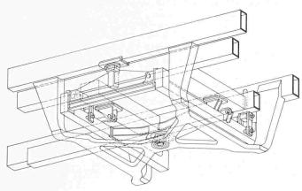
Bild 12. Drehgestell mit Drehzapfen der Lokomotive Reihe 1010
