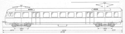
Bild 14. Personentriebwagen Reihe 4030. Alle Typenskizzen im Masstab 1:175
