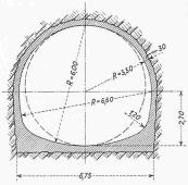
Bild 3. Querschnitt 1:200 des Durchstichs
