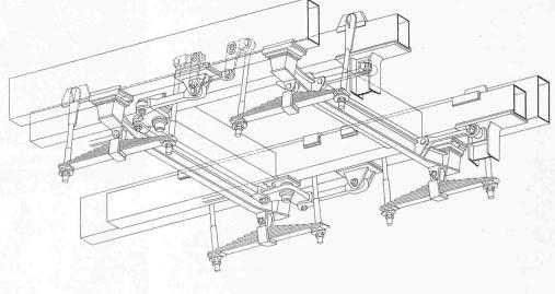
Bild 11. Drehgestell ohne Drehzapfen der Lokomotive Reihe 1010
