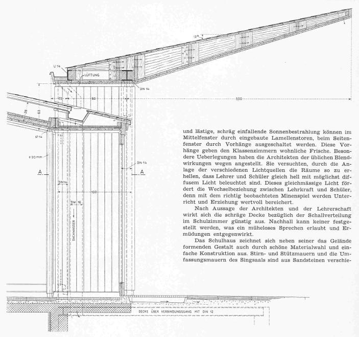
Bild 8. Schnitt 1:25 durch Klasseneingang und Vordach
