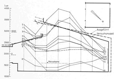
Bild 3. Lichtmessung am Modell und am ausgeführten Bau des Schulhauses Matt in Hergiswil (vgl. Tabelle 1)
