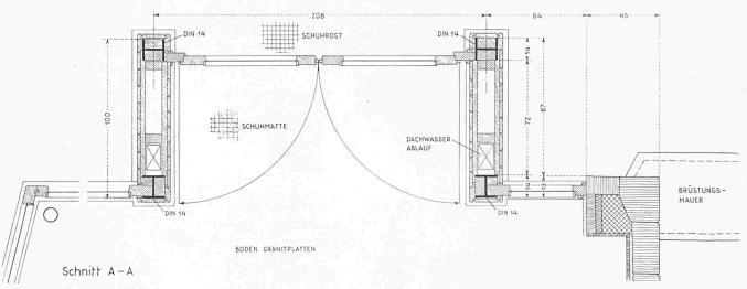
Bild 9. Grundriss des Klasseneinganges, Masstab 1:25
