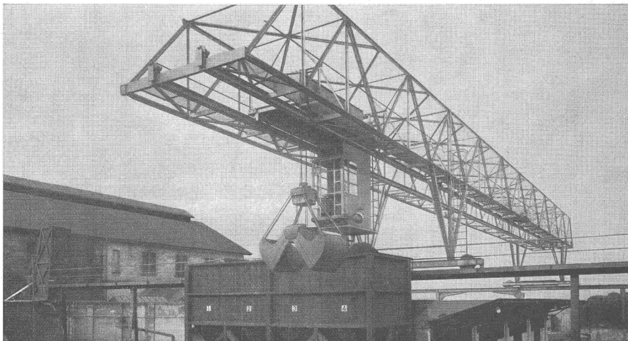
Verladebrücke in Schweisskonstruktion 2,5 t Tragkraft, 46 m Länge
