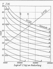
Bild 7. Kennlinien der Lokomotiven Reihen 1040 und 1041
