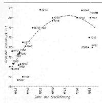
Bild 2. Achsdruck und Lieferjahr elektrischer Lokomotiven
