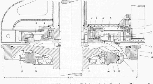
Bild 8b. Konstruktive Durchbildung des Gummiringfederantriebs der Siemens-Schlukkertwerke A.-G.
