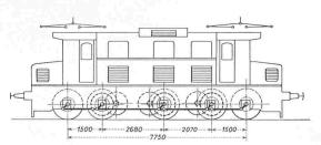
Bild 3. Güterzuglokomotive Reihe 1080
