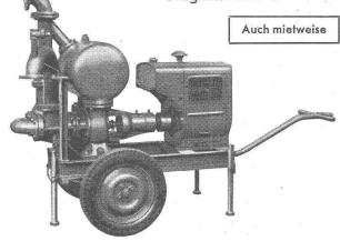
Leistungen 1—500 l/sek, Kein Bodenventil. Keine Klappe im Saugstutzen. Keine Hilfs-Vakuum-Pumpe. Jederzeitiges automatisches Ansaugen auch nach Lufteinfritt im Saugrohr. Keine reibenden, sich abnützenden Dichtungsflächen, daher störungsfrei auch bei Schlamm-, Sand- und Kiestörderung.
