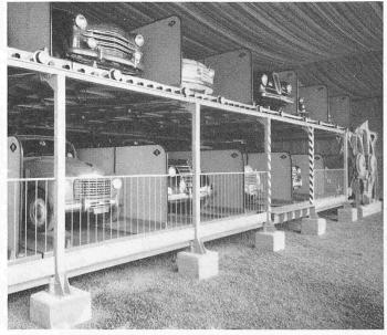
Bild 3, Untere und obere Boxenreihe sowie Mittelteil-Traggerüst mit Wagenentnahmepforte (Schiebebühne fehlt)
