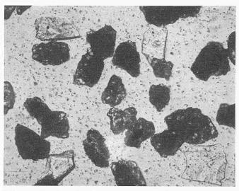
Bild 4. Mikroskopisches Präparat der Siebfraktion 0,06 — 0,09 mm eines PCS5, wie sie zum Auszählen des Schlackengehaltes verwendet werden. Farblose Körner mit «glasigem» Bruch — Hochofenschlacke; die übrigen dunklen Körner — PC-Komponenten. Durchfallendes Licht; Vergrösserung rd. 150fach
