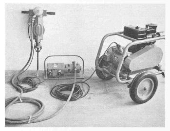
Bild 1. Links der Bohrhammer, in der Mitte die Gebläse-Gruppe, rechts das fahrbare Benzinmotor-Drehstromgenerator-Aggregat
