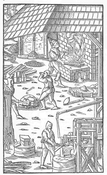
Bild 2. Rennfeuer. A Herd, B Beschickungshaufen, C Schlackenabfluss, D Eisenklumpen (Massel), E Holzhämmer, F grosser eiserner Hammer, G Amboss
