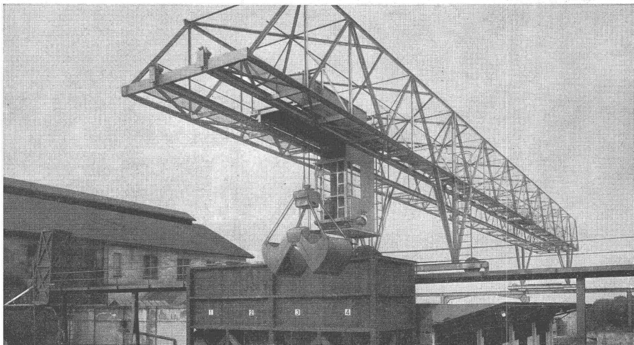
Verladebrücke in Schweisskonstruktion 2,5 t Tragkraft, 46 m Länge
