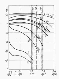
Bild 6. Gleiche Kennlinien wie in Bild 5. jedoch als Abszisse  $\text{Durchflussziffer } \varphi_1 = \frac{4\ V}{\pi\ D_1^2\ u_1^2}$
