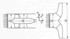
Bild 4. Die Durchflussziffer  $\varphi_2$  kennzeichnet beim Axialrad mit  $D_2 = D_1$  die Durchströmung, nicht aber beim Radialrad. Eine auf den Radinnendurchmesser bezogene Durchflussziffer ist für alle Radformen zweckmässig
