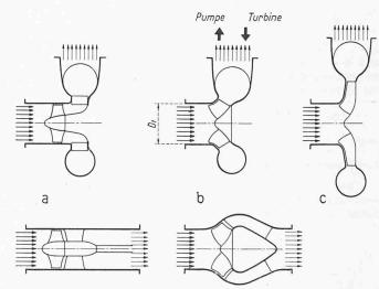
Bild 2. Allen Strömungsmaschinen gemeinsam ist der gesammelte Förderstrom am Ein- und Austritt der Maschine a Axialrad b Halbaxialrad c Radialrad
