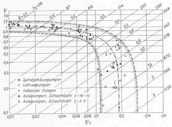
Bild 7. Druckziffer, Durchflussziffer und spezifische Schnelläufigkeit für verschiedenartige Kreiselpumpen
