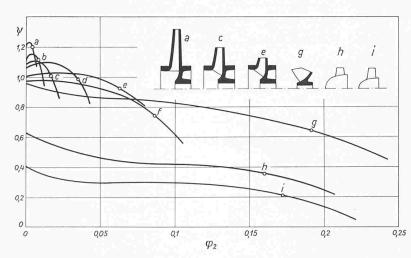
Bild 5. Dimensionslose Kennlinien von Kreiselpumpen verschiedener Schnellläufigkeit
