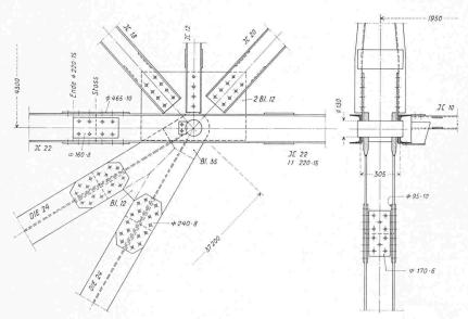
Bild 5. Knotenpunkt am Stützenkopf, Masstab 1:30
