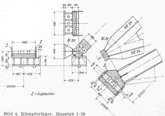
teilweise gespreizten Diagonalen und Pfosten aus zwei L-Eisen oder zwei [-Eisen sind an die Knotenbleche geschraubt. Der Obergurt ist in jeder Feldmitte längsbeweglich mit dem Randlängsträger verbunden, wodurch gegen Knicken in vertikaler Richtung eine elastische Stützung mitwirkt. Beim Knoten 13 geht der I-Untergurt in einen zweiwandigen ][-Querschnitt über, der den Anschlusszapfen der Schrägstütze aufnimmt (Bild 5). Dies ermöglichte eine Zentrierung der Stütze für jede Schräglage (Montage).
