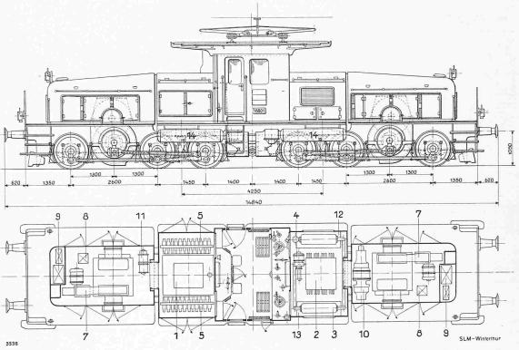
Bild 8. Ee 6/6-Lokomotive Serie 16 801 der Schweizerischen Bundesbahnen, gebaut von der Schweiz. Lokomotiv- und Maschinenfabrik Winterthur, der S.A. des Ateliers de Sécheron, Genf, und der AG. Brown Boveri & Cie., Baden. Typenbild 1:100
