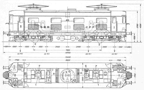
Bild 6. Re 4/4-Lokomotive Serie 401 der Schweizerischen Bundesbahnen, gebaut von der Schweiz. Lokomotiv- und Maschinenfabrik Winterthur, der Maschinenfabrik Oerlikon, der AG Brown Boveri & Cie, Baden, und der S. A. des Ateliers de Sécheron, Genf. Typenbild 1:120. 1 Ventilatorgruppen, 2 Triebmotoren, 3 Transformator, 4 Schützen, 5 Kompressorgruppe, 6 Bremsdosselspule, 7 Wendesphalter
