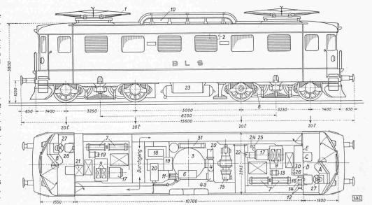
22 Bremsgenerator, platte. Akkumulatoren-Batterie (36 V, 90 bis 100 Ah), 24 el. pneum. Ventil für Stromabnehmer, 25 Handluft-
