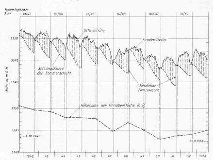
Bild 11. Höhenänderungen eines Punktes (P3) des Jungfraufirnes (rd. 350 m südlich der Sphinx)) von 1941 - 1953, Nach Kasser & Haefeli [9 u. 17]
