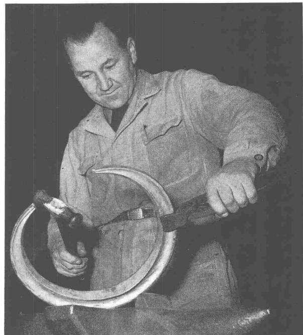
Schmieden eines Halbmondes aus Vierkant-Selva-Metall
