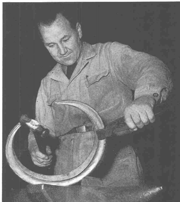
Schmieden eines Halbmondes aus Vierkant-Selva-Metall
