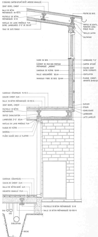
Fig. 14. Détails de construction, échelle 1:30
