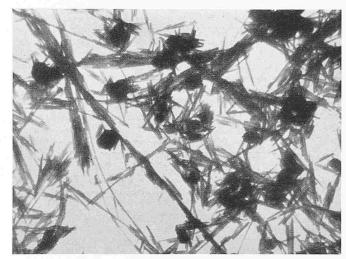
Bild 9. Synthetischer Chrysotil Bilder 6 bis 9. Elektronenmikroskopische Aufnahmen von natürlichen und von synthetischen Chrysotilasbesten bei gleicher 6500facher Ver-
