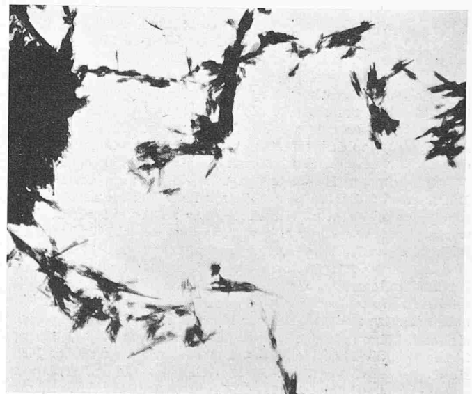
Bild 5. Synthetischer Chrysotilasbest. Elektronenmikroskopische Aufnahme bei 9000facher Vergrösserung. Haufwerk kleinster Kristalle
