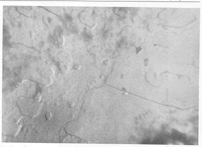
Bild 2. Elektronenmikroskopische Aufnahme einer gekrümmten Kristalloberfläche bei 9500facher Vergrösserung. Störung der Oberfläche durch Nebenkeime
