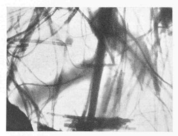
Bilder 10 und 11. Defokussierte elektronenmikroskopische Aufnahmen von Chrysotilasbest. Sog. «Röhrchenstruktur» der Chrysotilasern. Vergrösserung 40 000fach
