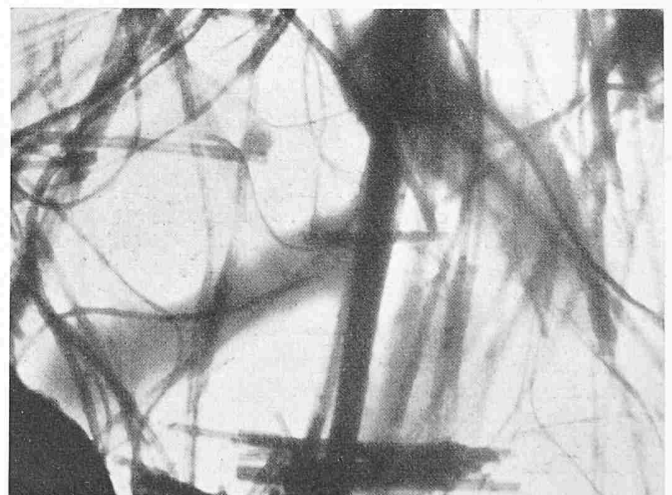
Bilder 10 und 11. Defokussierte elektronenmikroskopische Aufnahmen von Chrysotilasbest. Sog. «Röhrchenstruktur» der Chrysotilfasern. Vergrösserung 40 000fach
