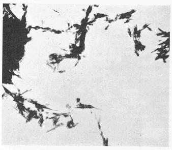
Bild 5. Synthetischer Chrysotilasbest, Elektronenmikroskopische Aufnahme bei 9000facher Vergrösserung, Haufwerk kleinster Kristalle
