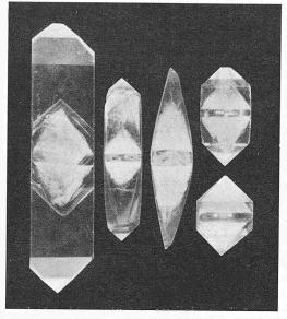
Bild 1. Synthetische NH<sub>4</sub> H<sub>2</sub> PO<sub>4</sub>-Kristalle und Kristallkeime. Anwachsen der äusseren klaren Teile an den Keim. Die beiden mittleren Kristalle weisen gekrümmte Flächen auf. ½ der natürlichen Grösse
