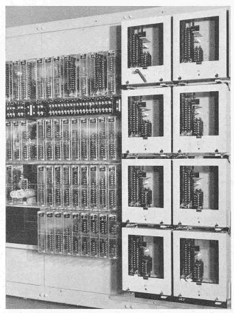
Bild 4. Steckbare Relaissätze (rechts) und gekapselte Einzelrelais
