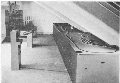
Bild 7. Modellbahn und Stellwerkanlage im Institut für Eisenbahn- und Verkehrs-Wesen der ETH. Links vorn elektrisches Schalterwerk, darüber die zugehörige Gleistafel, dahinter Stelltisch zum Dominostellwerk, an der Rückwand Stellwerk Bruchsal Bild 8 (links). Elektrisches Schaltwerk, Bauart Integra, darüber Gleisbild zur Anlage nach Bild 7
