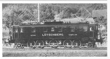
Bild 2. Ae 5/7-Lokomtive Serie 151 der Berner Alpenbahngesellschaft Bern-Lötschberg-Simplon, gebaut von der Schweiz. Lokomtiv- und Maschinenfabrik Winterthur und der Maschinenfabrik Oerlikon
