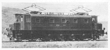
Bild 3. Ae 4/7-Lokomotive Serie 10901 der Schweizerischen Bundesbahnen, gebaut von der Schweiz, Lokomotiv- und Maschinenfabrik, der AG. Brown Boveri & Cie., Baden, und der Maschinenfabrik Oerlikon
