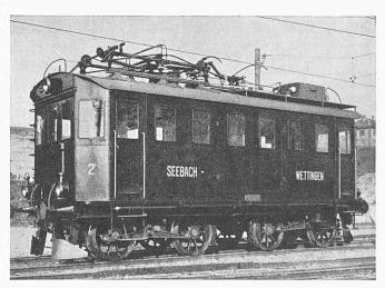
Bild 1. Die erste Einphasen-Wechselstromlokomtive gebaut 1905 für die Strecke Seebach—Wettingen von der Schweiz. Lokomotiv- und Maschinenfabrik Winterthur und der Maschinenfabrik Oerlikon
