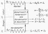
Kältemaschine, angetrieben von Dampfmaschine bzw. reversible Absorptionsmaschine
