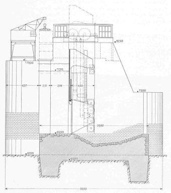
Bild 4. Stauwehr in Rochemaure der Kraftwerksstufe Montélimar an der Rhone. Querschnitt 1:350 durch das Wehr
