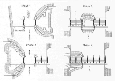
Höhenkote gebracht. Dabei müssen die Baugrubenabschlüsse auf den Vollstau dimensioniert werden, denn diese Abschlüsse dürfen erst dann erstellt werden, wenn die Schiffahrt durch den zukünftigen Kanal geleitet werden kann.
