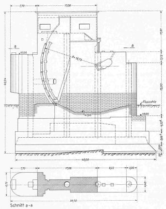
Bild 7. Stauwehr Donzère, Wehrpfeiler No. 6, Masstab 1:500
