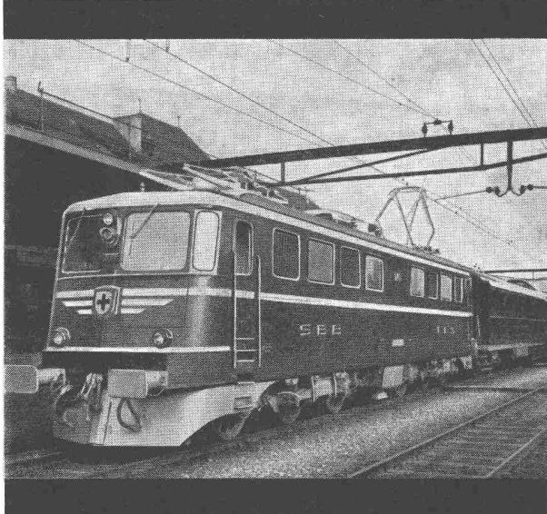
Elektrische Lokomotive von 6000 PS der SBB, mit dreiachsigen Drehgestellen unserer Sonderbauart
