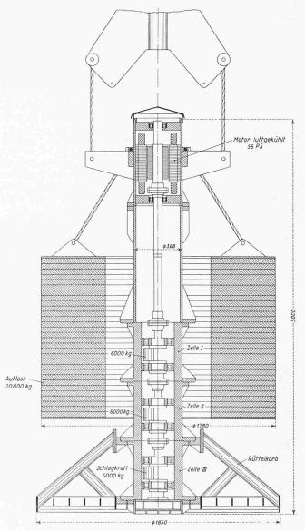
Bild 1. Querschnitt durch den Mammutrüttler, Masstab 1:25
